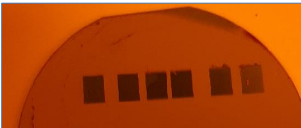
Abb. 4 Beispiel eines strukturierten AR-PC 5090.02 (schwarze Quadrate, Leitfähigkeit: 0,05 S/cm, prozessiert mit AR-N 4340 in einem Zweischichtverfahren) auf einem Siliziumwafer
